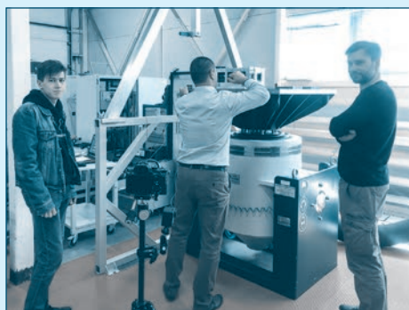
Рис. 7. Вибродинамические испытания УмКА-1
