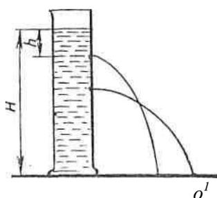
Но дальность струи определяется не только начальной скоростью воды, но и временем ее падения, которое тем меньше, чем ниже отверстие, из которого вытекает вода. Если использовать обозначения, показанные на рисунке, то скорость вылета воды из отверстия, находящегося на высоте  $h$  от верхнего уровня жидкости,
