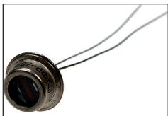
Рис. 72. Фоторезистор ФРТ 765. Если направить на фоторезистор свет, то его сопротивление уменьшается более чем в 100 раз. Прибор работает в оптическом диапазоне
