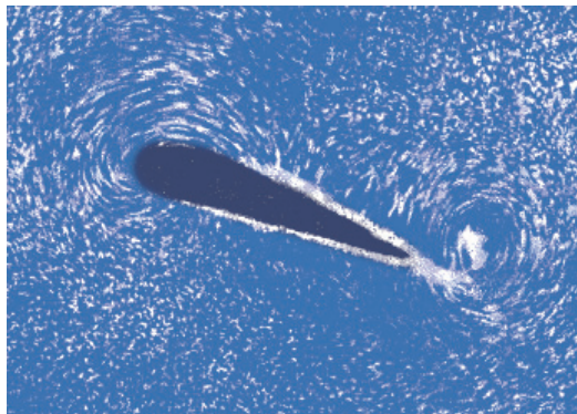
Рис. 29. Образование вихря вблизи задней кромки крыла самолёта.
