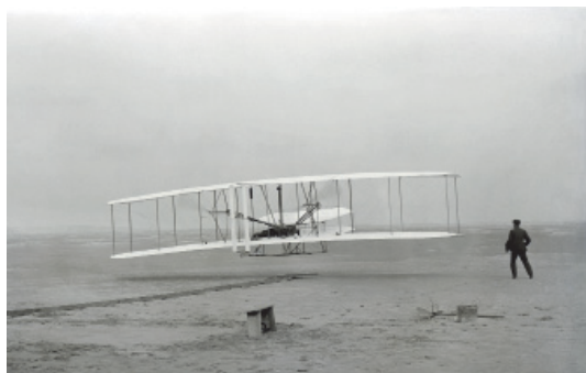
Рис. 24. Первый успешный полёт «Флайера-1» 17 декабря 1903 г. «Флайер-1» имел размах крыла 12 м, массу 283 кг и был оснащён двигателем мощностью 9 кВт
