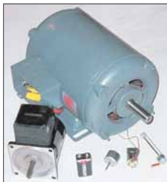
Рис. 214. Электродвигатели разной мощности (750 Вт, 25 Вт, к CD-плееру, к игрушке, к дисководу)
