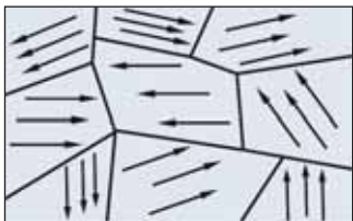
Рис. 195. Модель внутреннего строения ферромагнетиков. Области намагничивания ориентированы произвольно. Стрелками показано направление силовых линий магнитного поля каждой из областей
