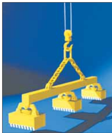
Рис. 220. Грузоподъёмный электромагнит ЭМП16. Напряжение питания 220 В. Электрическая мощность 3,85 кВт. Масса поднимаемых листов стали до 660 кг
