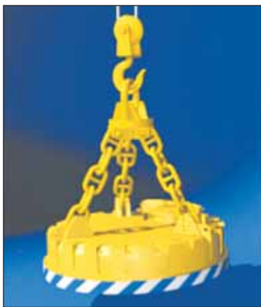
Рис. 219. Грузоподъёмный электромагнит ЭМ42. Напряжение питания 220 В. Электрическая мощность 11 кВт. Масса поднимаемой стружки до 200 кг
