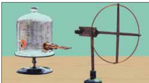
Рис. 68. Экспериментальная установка Г. Герца по изучению электромагнитных волн
