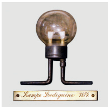
Рис. 36. Лампа накаливания Лодыгина 1874 года. Отличительной особенностью является накаливание угольного стерженька в герметически закрытом баллоне. Лампа демонстрировалась на Парижской международной электротехнической выставке 1881 года, на Первой и Второй электротехнических выставках в Санкт-Петербурге в 1880 и 1882 годах
