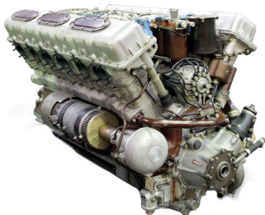
Рис. 14. ЧТЗ. Дизельный двигатель В-59 УМС. Челябинский тракторный завод
