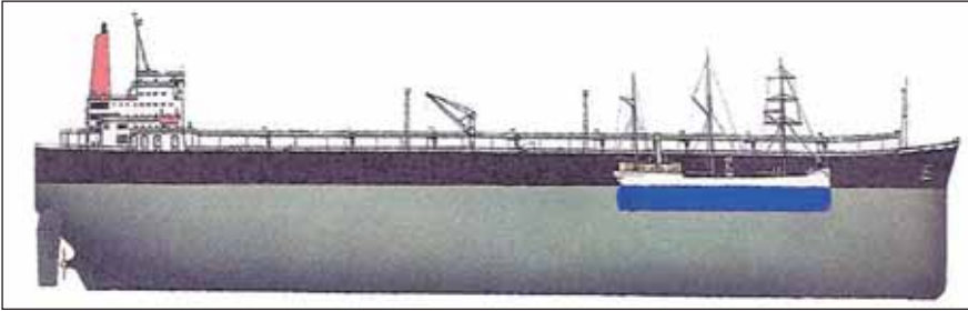
Рис. 230. Так за 100 лет выросли размеры нефтеналивных судов. Супертанкер «Батиллус». 1976–1985 г. Франция. Длина – 414,2 м; ширина – 63 м; грузоподъёмность – 553 662 т; осадка – 28,6 м; скорость – 17 узлов (около 35,1 км/ч)
