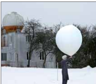
Рис. 232. Запуск радиозонда на метеорологической станции
