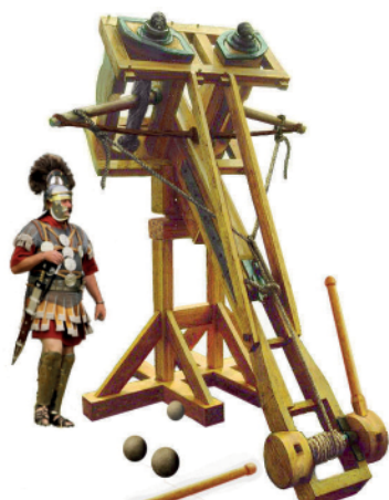
Римская баллиста для метания камней массой 26 кг. (Пропорции взяты с реальной баллисты, построенной в наше время для одной из телевизионных передач)
