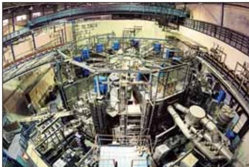
Рис. 181. Токамак Т-15 (Национальный исследовательский центр «Курчатовский институт»). Имеет сверхпроводящий магнит, дающий поле с индукцией 3,6 Тл. Ток плазмы – до 1 000 000 А
