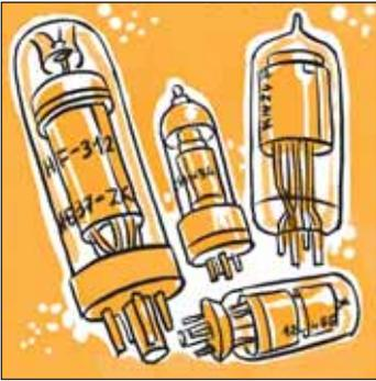
Электрoвакуумные приборы (ЭВП) – электронные приборы, в которых рабочее пространство освобождено от воздуха... Работа ЭВП основана на взаимодействии потока электронов, испускаемых катодом, с постоянными и переменными электрическими и магнитными полями.
